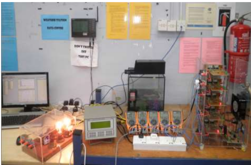
(a) Beban lampu resistif 30 W dan pompa air 20 W
