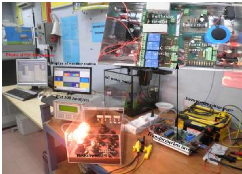
Gambar 6.20 Pengaturan eksperimental TPVI satu fase tiga tingkat berdaya rendah
