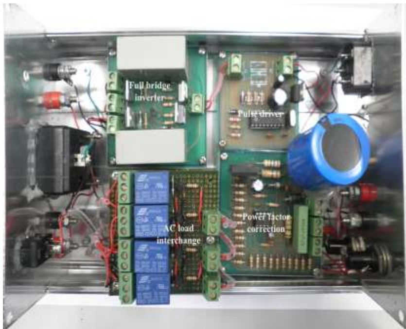
Gambar 6.13 Merakit TPVI tiga tingkat satu fase di dalam sebuah persegi
